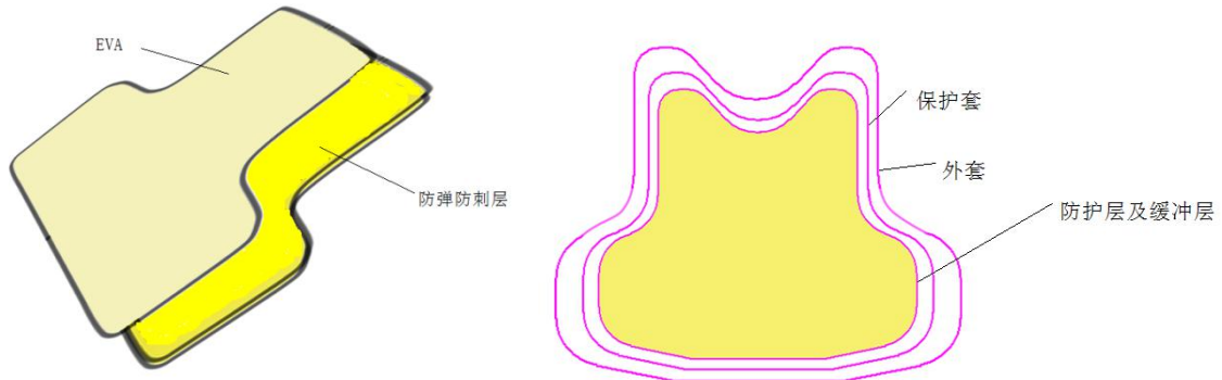
图 1 芯片及防弹防刺服结构示意图
